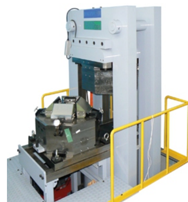
Установка генерирования давления и температуры Discoverer для изучения синтеза алмазов и материалов, расположенных внутри Земли на глубине 1000 км для ИГМ СО РАН
