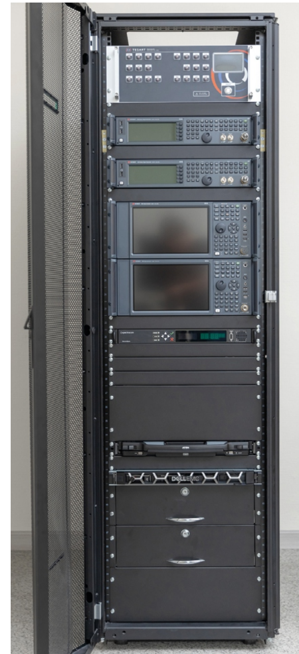
Комплект для измерения параметров и обработки алгоритмов работы полезной нагрузки спутника связи
