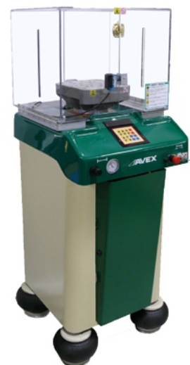
Установка для испытаний на ударную нагрузку AveX SM-110-MP с усилителем удара с целью отработки блоков изделий при ускорениях до 30 000g для АО «НИИЭП»
