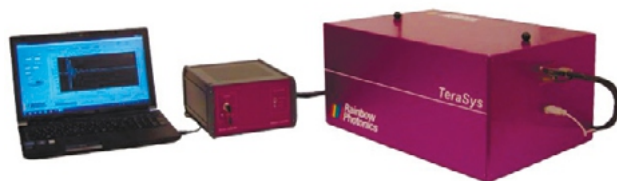
Система для ТГц спектроскопии и визуализации в широком оптическом диапазоне 0.3–14 ТГц
