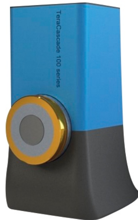
Поставка импульсного источника терагерцового излучения Lytid на диапазон 2-5 ТГц
